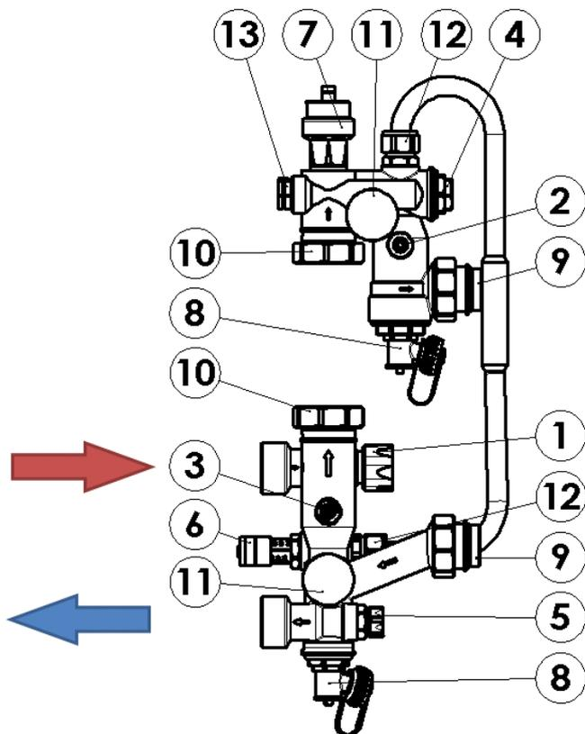
1. Valvola di regolazione termostaticabile (mandata caldaia) comandata con testa termostatica con sonda a distanza o tramite testa elettrotermica 0-10V o motore elettrico 3 punti o 0-10V
