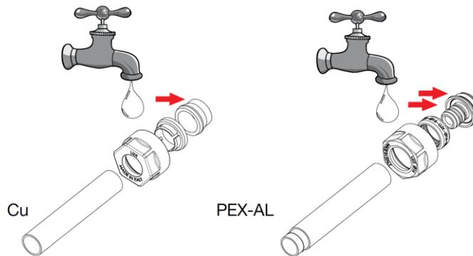
È assolutamente vietato lubrificare le parti in gomma con oli o grassi a base minerale: la miscela EPDM è compatibile solo con lubrificanti a base siliconica. Per evitare qualsiasi equivoco, si consiglia di lubrificare le parti in gomma semplicemente con acqua.
