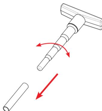
2. **Calibratura.** Questa operazione consente di ottenere il diametro interno corretto.
