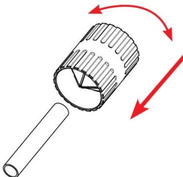
3. **Svasatura.** L'operazione di svasatura crea uno smusso interno che facilita l'inserimento dei raccordi nel tubo ed evita che gli o-rings possano fuoriuscire dalle loro sedi.
