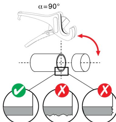
1. **Taglio del tubo.** Per eseguire un taglio corretto, utilizzare le cesoie apposite in modo da non ovalizzare il tubo e facendo particolare attenzione che il taglio sia perpendicolare all'asse del tubo.
