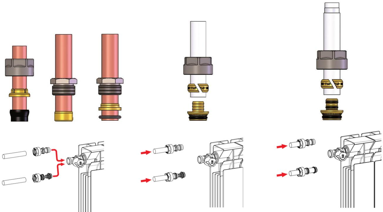
Inserire il tubo con relativo portagomma nella tasca del raccordo avendo cura che la stessa sia pulita ed evitando di pizzicare l'o-ring di tenuta.
