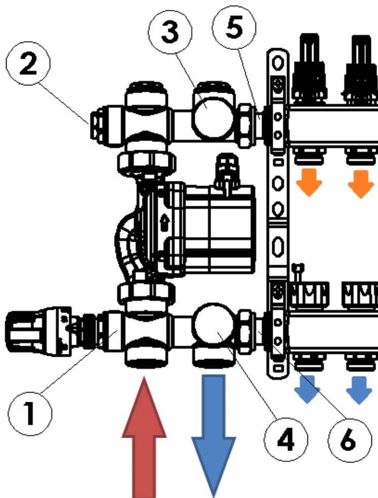
1. Valvola di regolazione termostattabile comandata con testa termostatica con sonda a distanza o tramite testa elettrotermica 0-10V o motore elettrico 3 punti o 0-10V
