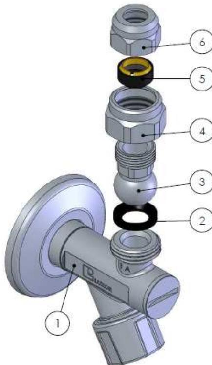
Per il corretto montaggio dei collegamenti rigidi sottolavabo è necessario attenersi alla sequenza sopra indicata, verificando scrupolosamente il verso di assemblaggio di cartuccia e guarnizioni.
