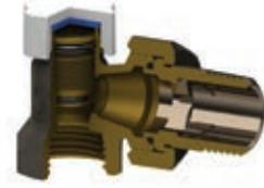
La tenuta in chiusura con l'otturatore è assicurata da un o-ring e da una tenuta conica metallica. I detentori sono prodotti con finitura nichelata. Tutti i detentori hanno la possibilità di regolare la portata limitando l'alzata dell'otturatore.
