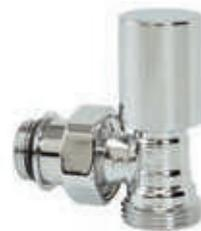
Le valvole Serie 30 hanno un vitone che offre la possibilità di prerogolazione grazie ad un anello in acetalica sagomato. Il vitone termostatico permette la sostituzione di uno degli o-ring di tenuta sull'asta di comando senza che sia necessario svuotare l'impianto. Le valvole sono prodotte con finitura cromata.
