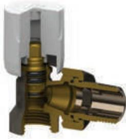
La tenuta in chiusura con l'otturatore è assicurata da un o-ring e da una tenuta conica metallica. Le valvole sono prodotte con finitura nichelata. L'apertura delle valvole e detentori deve essere effettuata con pressione differenziale inferiore a un 1 bar.
