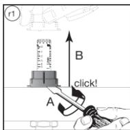
Il valore della portata teorica di un circuito idraulico, stabilito dal tecnico, è determinato dalla regolazione effettuata tramite i flussimetri posizionati sul collettore di mandata. La regolazione deve avvenire con la valvola posta sul ritorno completamente aperta. Dato che le portate di ciascun anello si influenzano tra loro, è importante che le regolazioni siano effettuate per ogni anello fino all'effettivo raggiungimento dei valori di portata in l/min stabiliti dal progetto.
