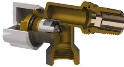
Le valvole manuali serie M utilizzano un'asta fissa la cui tenuta è garantita da un o-ring e da una guarnizione piana in PTFE regolabile da una ghiera premistoppa in ottone. La tenuta in chiusura con l'otturatore è assicurata da un o-ring e da una tenuta conica metallica. Le valvole termostattizzabili
