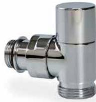
I detentori serie 50<sup>th</sup> hanno la tenuta assicurata da un o-ring sull'otturatore e se necessario da un ulteriore o-ring tra il corpo e il tappo. La tenuta in chiusura con l'otturatore è assicurata da un o-ring e da una tenuta conica metallica. Tutti i detentori hanno la possibilità di regolare la portata limitando l'alzata dell'otturatore.
