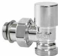
I detentori serie 30 hanno la tenuta assicurata da un o-ring sull'otturatore e se necessario da un ulteriore o-ring tra il corpo e il tappo. La tenuta in chiusura con l'otturatore è assicurata da un o-ring e da una tenuta conica metallica. Tutti i detentori hanno la possibilità di regolare la portata limitando l'alzata dell'otturatore.
