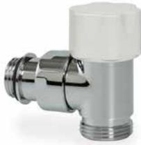
Le valvole serie 50<sup>th</sup> hanno un vitone che offre la possibilità di preregolazione grazie ad un anello in acetalica sagomato. Il vitone termostatico permette la sostituzione di uno degli o-ring di tenuta sull'asta di comando senza che sia necessario svuotare l'impianto.
