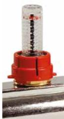
I collettori di regolazione e bilanciamento, con regolatori e misuratori di portata TM 4012, danno la possibilità di una immediata verifica del bilanciamento dell'impianto attraverso la lettura della portata. La regolazione può essere bloccata tramite un coperchio d'arresto. Il bicchiere e la molla di misurazione possono essere smontati e puliti con l'impianto in funzione. Questo collettore deve essere installato sulla mandata.
