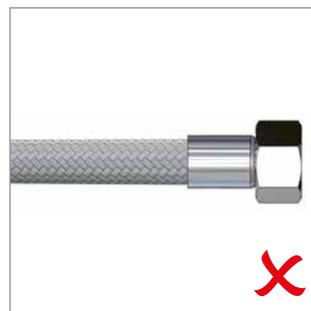
I flessibili devono mantenere un tratto rettilineo in corrispondenza dei raccordi pari a 4 volte il diametro esterno del tubo (DN6 = Ø 10mm → tratto rettilineo 40 mm), il raggio di curvatura non deve essere inferiore a 4 volte il diametro esterno del tubo (DN6 = Ø 10mm → raggio di curvatura 40 mm).
