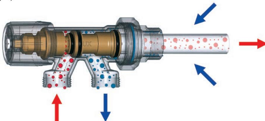
La valvola M 88 in posizione di chiusura ha il bypass al 100% della portata dell'anello, dunque non entra liquido nel corpo scaldante.
