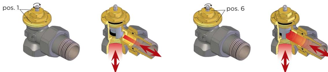
Le valvole termostatiche Luxor possono funzionare anche in condizione di flusso inverso. Grazie a questa caratteristica possono essere installate sia sulla mandata sia sul ritorno del radiatore fino ad una pressione differenziale di 0,6 bar.
