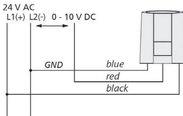
Montati su valvole di controllo, gli azionatori TE 3020 eseguono come elementi di regolazione modulanti (continui) molteplici compiti di azionamento e regolazione.
