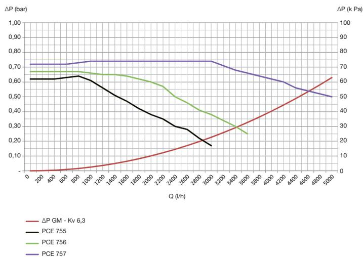
Per evitare eccessive rumorosità dell'impianto, evitare l'impiego con valori di  $\Delta P$  superiori a 0,2-0,25 bar.
