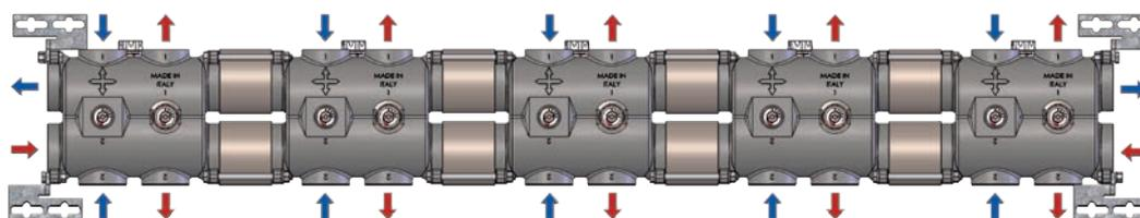
Il collettore CD 1210, se assemblato tutto nello stesso verso, ha un funzionamento idraulico uguale a quello di un classico collettore complanare con gli attacchi alternati su entrambi i lati del collettore e attacchi principali di testa da G 1"1/2.
