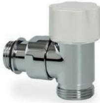
Le valvole serie 50<sup>th</sup> hanno un vitone che offre la possibilità di preregolazione grazie ad un anello in acetilica sagomato. Il vitone termostatico permette la sostituzione di uno degli o-ring di tenuta sull'asta di comando senza che sia necessario svuotare l'impianto.
