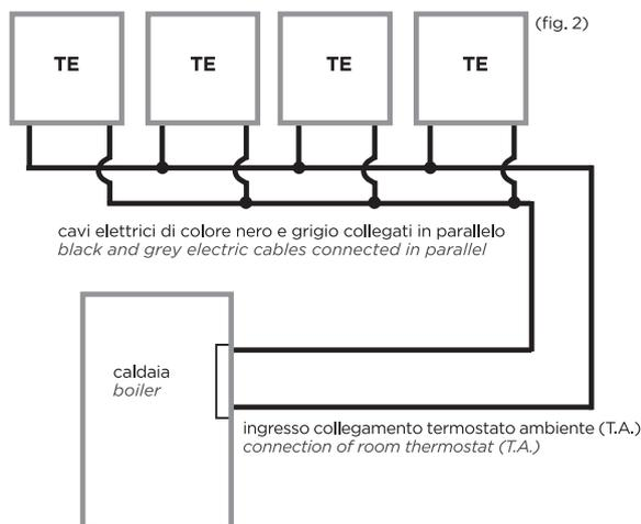
Teste termoelettriche con contatto di fine corsa art. TE 3112
