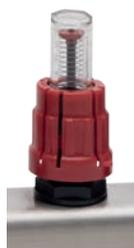
I collettori di regolazione e bilanciamento, con regolatori e misuratori di portata TM 4014, danno la possibilità di una immediata verifica del bilanciamento dell'impianto attraverso la lettura della portata. La regolazione può essere bloccata tramite un coperchio d'arresto. Il bicchiere e la molla di misurazione possono essere smontati e puliti con l'impianto in funzione. Questo collettore deve essere installato sulla mandata.
