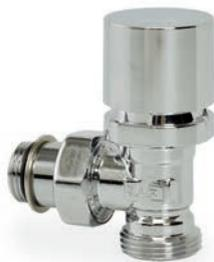
Le valvole Serie 30 hanno un vitone che offre la possibilità di prerogolazione grazie ad un anello in acetalica sagomato. Il vitone termostatico permette la sostituzione di uno degli o-ring di tenuta sull'asta di comando senza che sia necessario svuotare l'impianto. Le valvole sono prodotte con finitura cromata.
