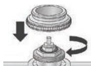
1. Avvitare manualmente l'adattatore della valvola sulla valvola stessa.
