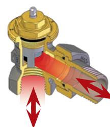
Le valvole termostatiche Luxor possono funzionare anche in condizione di flusso inverso. Grazie a questa caratteristica possono essere installate sia sulla mandata sia sul ritorno del radiatore fino ad una pressione differenziale di 0,6 bar.
