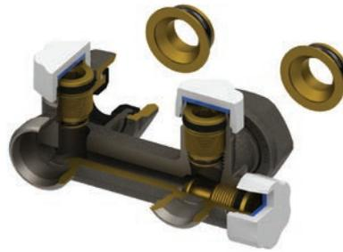
I distributori hanno la tenuta assicurata da un o-ring e da una guarnizione piatta all'interno del tappo. La tenuta in chiusura con l'otturatore è assicurata da un o-ring e da una tenuta conica metallica.
