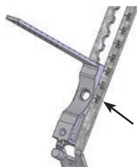
**2.** Allineare il foro centrale con l'interasse voluto (esempio nell'immagine 200mm), regolazione da 200mm a 260mm.
