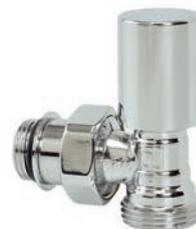
La valvola manuale Serie 30 utilizza un'asta fissa la cui tenuta è garantita da due o-rings. La tenuta in chiusura con l'otturatore è assicurata da un o-ring e da una tenuta conica metallica. L'apertura delle valvole e detentori deve essere effettuata con pressione differenziale inferiore a un 1 bar.
