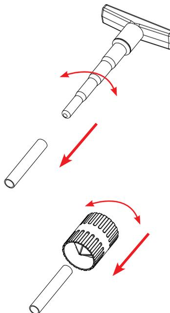
**3. Svasatura.** L'operazione di svasatura crea uno smusso interno che facilita l'inserimento dei raccordi nel tubo ed evita che gli o-rings possano fuoriuscire dalle loro sedi.
