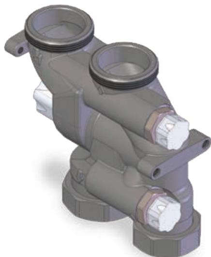
Valvola miscelatrice DN 25. Può essere abbinata alla testa termostatica per impianti a punto fisso TT 3051, oppure ad un attuatore che abbia il filetto M30x1,5, con punto di chiusura 11,5 mm e corsa  $\geq 3$  mm.
