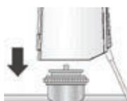
3. Posizionare manualmente l'attuatore in posizione verticale sull'adattatore della valvola.
