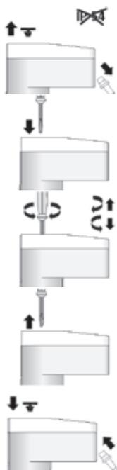
**1.** Rimuovere la cavo di connessione e il tappo di protezione.
