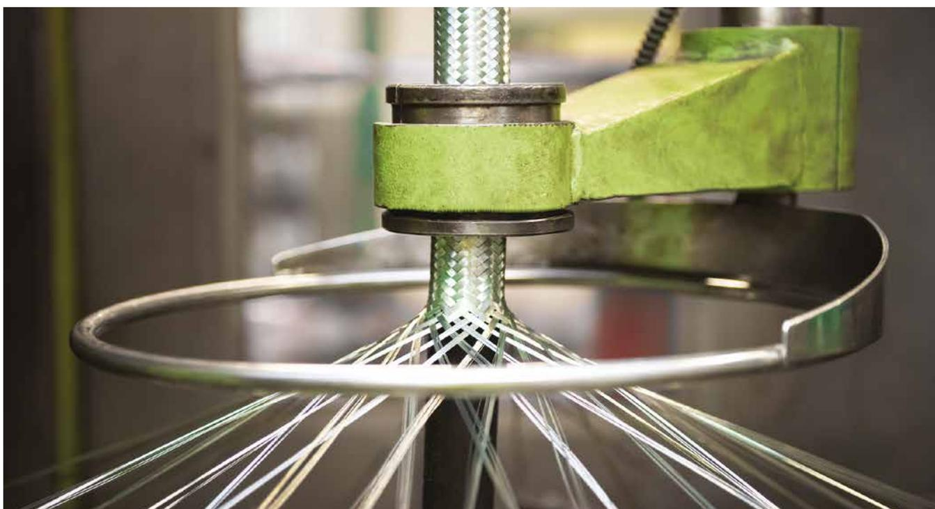
La treccia esterna di rinforzo viene realizzata utilizzando fili di acciaio inox AISI 304  $\varnothing$  0,20 mm,  $\varnothing$  0,22 mm, fili in acciaio zincato  $\varnothing$  0,30 mm e fili in Nylon PA 6.6  $\varnothing$  0,25 mm e  $\varnothing$  0,30 mm.
