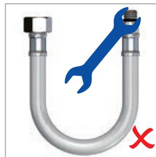
Non utilizzare alcun attrezzo sulla bussola di serraggio. Una forza applicata a questa bussola ne determina spesso il danneggiamento e la conseguente rottura del tubo flessibile.
