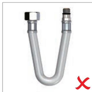
Non installare il tubo flessibile in condizioni di torsione o tensione.
