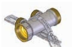
**6.** La fascetta può essere bloccata in 2 modi. Il primo prevede di inserire il perno fisso del cavallotto in uno dei fori della fascetta. In questo modo si ottiene un posizionamento del prodotto senza l'utilizzo di utensili. In alcune installazioni potrebbe essere sufficiente perché non è necessario ancorare saldamente il collettore.
