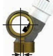
Le uscite dei collettori sono disassate di 4 mm per facilitare l'assemblaggio dei raccordi nella cassetta.
