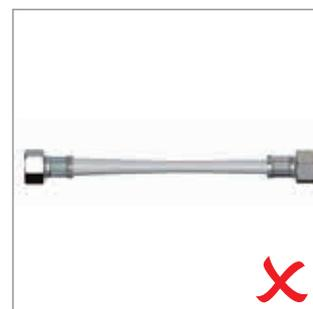
I flessibili devono poter essere ispezionati. Non installare all'interno di muri o in cunicoli non ispezionabili. Non rivestire con materiale isolante (tranne in caso di flessibili con treccia inox e bussole inox).
