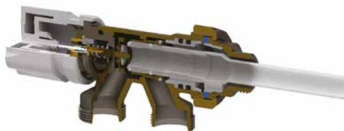
Le valvole monotubo termostattizzabili, se equipaggiate con la testa termostatica e con un  $\Delta t=2K$ , consentono di alimentare il corpo scaldante con una portata pari al 35% della portata totale del circuito. Il vitone termostatico permette la so-
