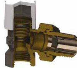
Le valvole ThermoTekna hanno un vitone che offre la possibilità di prerogolazione grazie ad un anello in acetilica sagomato. Il vitone termostatico permette la sostituzione di uno degli o-ring di tenuta sull'asta di comando senza che sia necessario svuotare l'impianto. Le valvole, dove segnalato, sono certificate UNI EN215. Le valvole sono prodotte con finitura nichelata. L'apertura delle valvole e detentori deve essere effettuata con pressione differenziale inferiore a un 1 bar.
