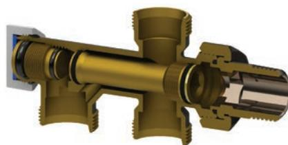
I distributori hanno la tenuta verso l'esterno assicurata da un o-ring e da una guarnizione piatta all'interno del tappo. La tenuta in chiusura con l'otturatore è assicurata da un o-ring.
