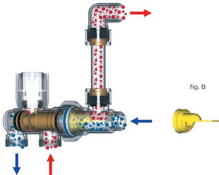
Se in fase di installazione non dovesse essere rispettato il senso della freccia utilizzare il setto come in figura B.
