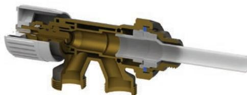
Le valvole monotubo utilizzano un'asta fissa la cui tenuta è garantita da un o-ring e da una guarnizione piana in teflon regolabile da una ghiera premistoppa in ottone. Le valvole sono prodotte con finitura nichelata.
