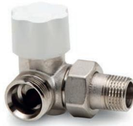
Le valvole coassiali hanno un vitone che offre la possibilità di prerogolazione grazie ad un anello in acetalica sagomato. Il vitone termostatico permette la sostituzione di uno degli o-ring di tenuta sull'asta di comando senza che sia necessario svuotare l'impianto. Le valvole sono prodotte con finitura nichelata.
