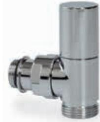
La valvola manuale serie 50<sup>th</sup> utilizza un'asta fissa la cui tenuta è garantita da due o-rings. La tenuta in chiusura con l'otturatore è assicurata da una guarnizione piatta. L'apertura delle valvole e detentori deve essere effettuata con pressione differenziale inferiore a un 1 bar.
