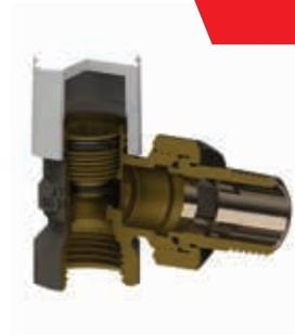
Le valvole ThermoTekna hanno un vitone che offre la possibilità di prerogolazione grazie ad un anello in acetilica sagomato. Il vitone termostatico permette la sostituzione di uno degli o-ring di tenuta sull'asta di comando senza che sia necessario svuotare l'impianto. Le valvole, dove segnalato, sono certificate UNI EN215. Le valvole sono prodotte con finitura nichelata. L'apertura delle valvole e detentori deve essere effettuata con pressione differenziale inferiore a un 1 bar.
