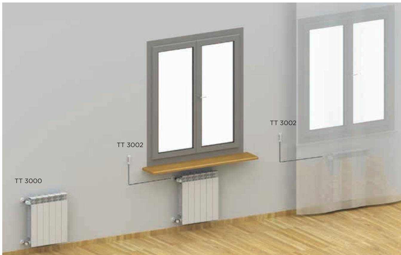
Le teste termostatiche **TT 3000** possono essere applicate a tutti i corpi scaldanti liberi di trasmettere il calore nell'ambiente. Nel caso ci siano barriere, come mensole, tendaggi o mobili, che possono immagazzinare calore e quindi falsare la rilevazione della temperatura ambiente da parte delle teste termostatiche, devono essere utilizzate teste termostatiche con sensore a distanza **TT 3002**.
