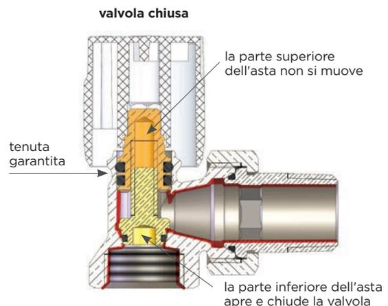
Tutte le valvole e i detentori vengono testati al 100% con prova di tenuta pneumatica a controllo elettronico.
