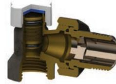
La tenuta in chiusura con l'otturatore è assicurata da un o-ring e da una tenuta conica metallica. Le valvole sono prodotte con finitura nichelata. L'apertura delle valvole e detentori deve essere effettuata con pressione differenziale inferiore a un 1 bar.
