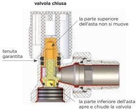
Tutte le valvole e i detentori vengono testati al 100% con prova di tenuta pneumatica a controllo elettronico. Le caratteristiche del fluido dell'impianto devono essere conformi alla direttiva UNI 8065:2019.
