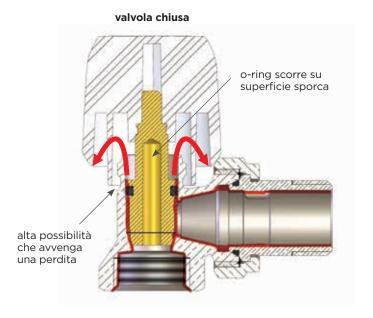
I vantaggi dell'asta realizzata in due pezzi sono molteplici e si verificano sia con la valvola aperta sia con la valvola chiusa.
